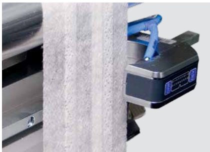
Infrared edge sensor FR 46 on non-woven fabric edge
